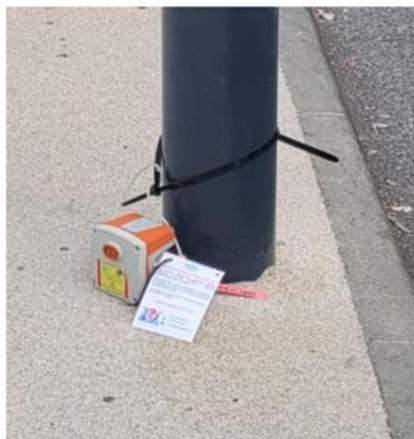
Géophone placé dans différents environnements (largeur ~20 cm) ©S 3
