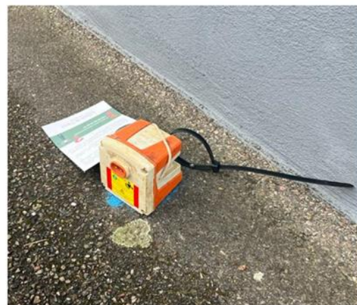
Géophone placé dans différents environnements (largeur ~20 cm) ©S 3
