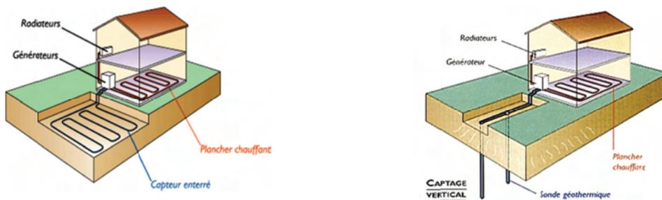
*Solution capteur horizontal enterré*
