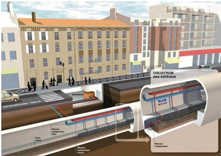
Figure 12 – Schéma de fonctionnement d'une PAC sur eaux usées – Cas de la rue de Wattignie et du Palais de l'Élysée (Source Degrés-Bleus et UHRIG)
