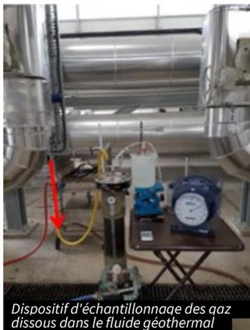
Dispositif d'échantillonnage des gaz dissous dans le fluide géothermal
