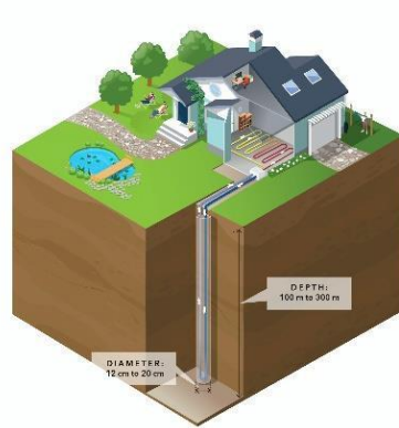
Sonde géothermique verticale
