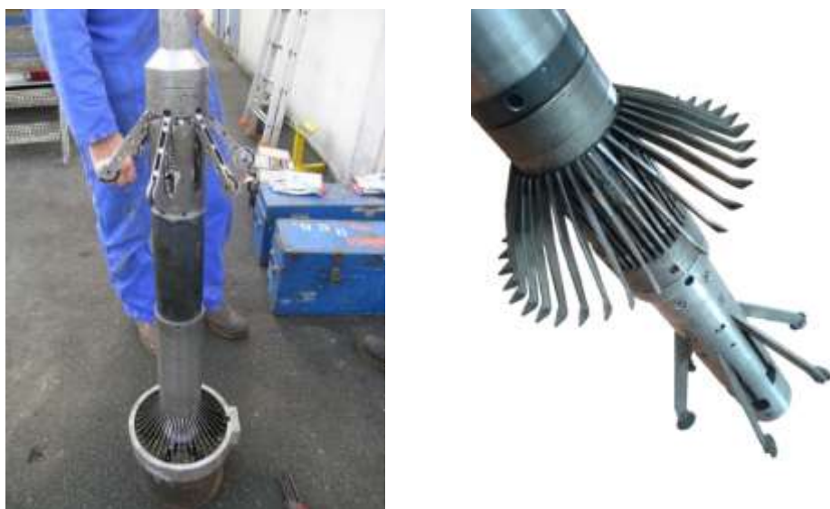
Figure 1. Exemple de diamètreur mécanique à 40 bras
