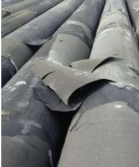
Figure 3 : Débris sous forme de plaques de sulfure de fer et morceau d'un bridge-plug reforé
