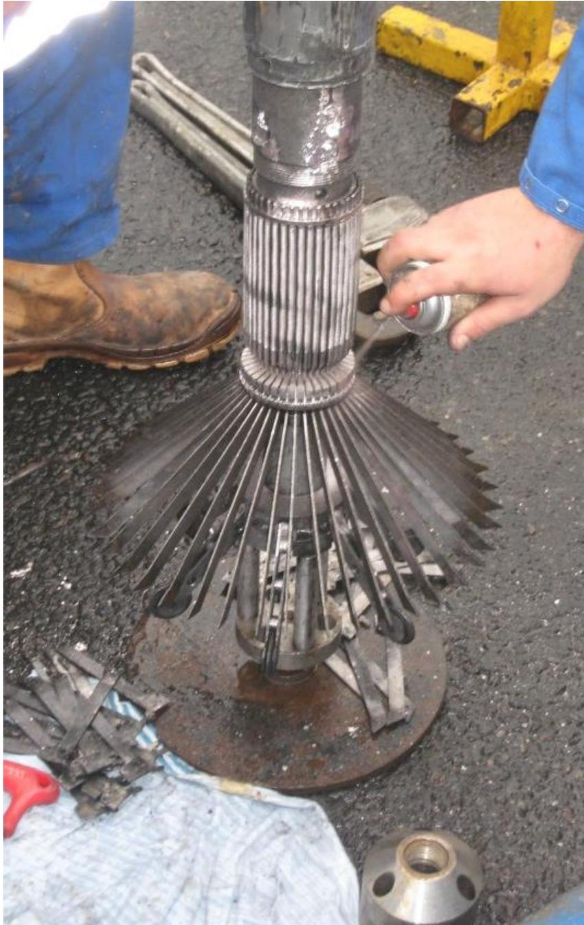
Figure 8 : Diamètreur 40 bras ouverts avant calibrage.
