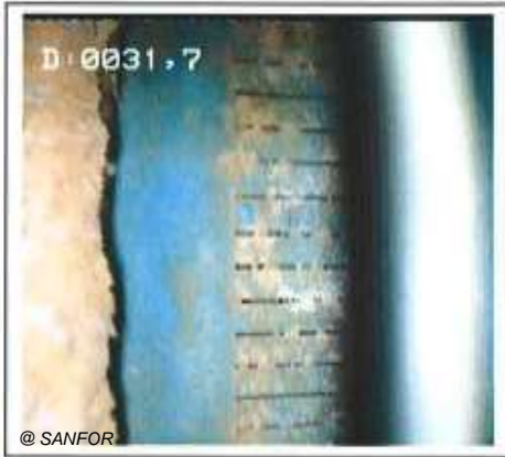
Inspection vidéo d'un encrassement des crépines – Mauvaise régulation
