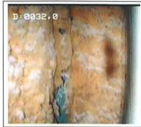
Inspection vidéo d'un encrassement des crépines – Mauvaise régulation
