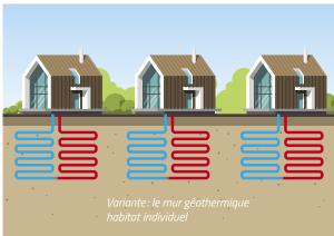
Dans le cas du mur géothermique ou de la sonde géothermique verticale, la pompe à chaleur est constituée d'un circuit fermé et étanche dans lequel circule un fluide frigorigène qui transfère les calories captées dans le sous-sol vers la maison pour la chauffer et produire l'eau chaude sanitaire. Le cycle peut aussi être inversé pour produire du froid en période estivale à condition de disposer d'émetteurs adéquats.
