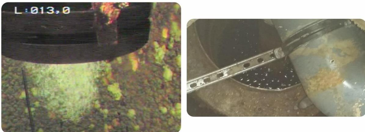
Figure 19 : Oxygénation de l'eau géothermale en raison d'une boucle primaire non en charge. L'injection de bulles d'air est visible sur les extraits des inspections vidéo (Gauche : Base de la colonne d'injection, Droite : surface de l'eau en tête du forage d'injection)
