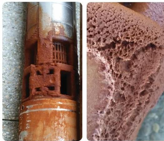
Figure 12 : Pompe d'exhaure recouverte d'hydroxydes amorphes de fer
