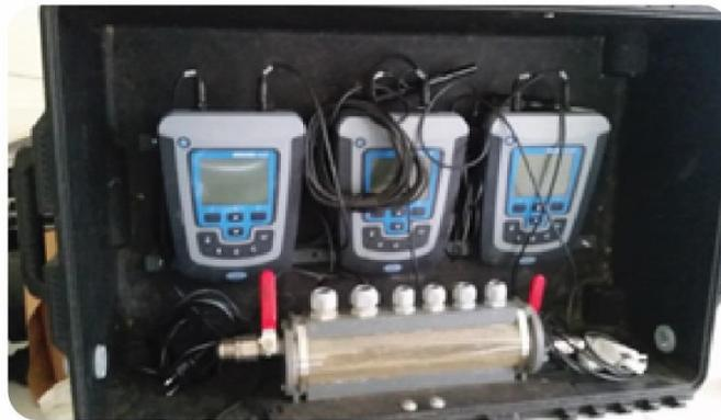
Figure 30 Exemple de cellule à flux continu destinée à la mesure des paramètres physico-chimiques des eaux de forage
