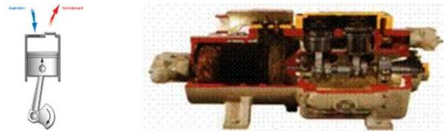
Figure 4 : Compresseur Piston (Source Dalkia)
