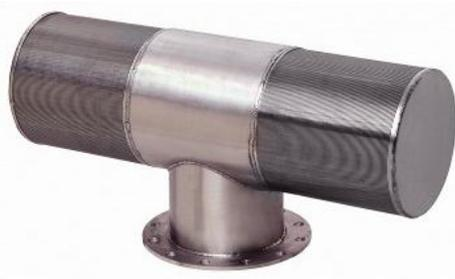
Des filtres peuvent aussi être installés directement à l'aspiration. Cela simplifie les moyens de filtrations suivants mais impose une vitesse de passage extrêmement faible et des matériaux qui vont limiter la prolifération des mollusques et algues. Un système de chasse d'air permet le décolmatage du filtre en fonction de la perte de charge ou suivant une horloge.
