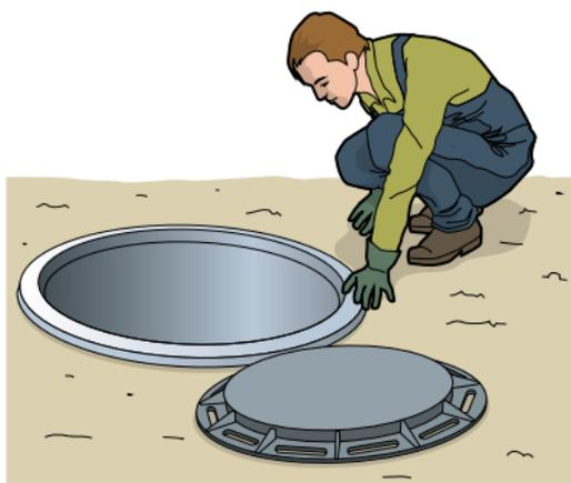
Le regard de collecte des condensats et la prise d'air neuf sont deux points sensibles nécessitant une vigilance particulière à une fréquence minimale de 2 fois par an.
