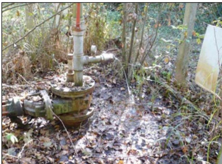
Figure 81 : Photographie du forage de L'Ouche (émergence minière du bassin de Blanzky-Montceau).
