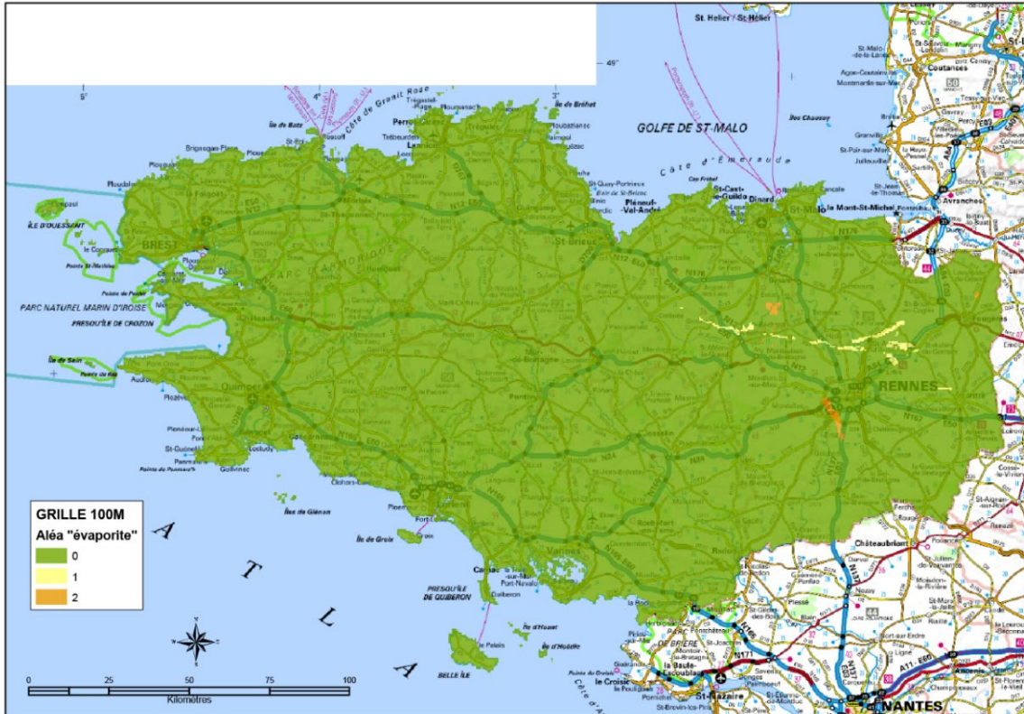
Figure 8 : Carte montrant les résultats du traitement concernant l'aléa « affaissement et surrection liés aux formations évaporitiques » pour la tranche de profondeur 10-100 m.
